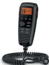
Segunda estação para rádio VHF, com fio e compatível com VHF 215, VHF 215 Garmin AIS e VHF 315. Display de 2", flexibilidade de montagem usando o cabo de extensão de 32' do rádio e conveniente cabo enrolado de 1' a quase 5' para o aparelho.
