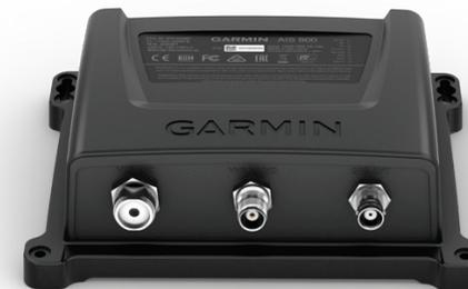
O AIS 800 tem um divisor de antena VHF interno, que permite que os sistemas VHF e AIS compartilhem uma única antena. Inclui um GPS integrado (com conector para antena externa opcional) e integra-se perfeitamente com os sistemas Garmin. O transceptor possui conectividade NMEA 2000/0183<sup>®</sup> para fácil integração com chartplotters compatíveis e displays multifuncionais.
