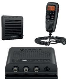
Rádio VHF modular "Black Box" com receptor GPS integrado<sup>1</sup>. Inclui aparelho GHS 11 VHF e alto-falante ativo para usar como intercomunicador entre até 3 estações. Conecte um hailer com capacidade de 30 watts para transmissão bidirecional. Fácil instalação plug-and-play para chartplotters e MFDs compatíveis da rede NMEA 2000®.
