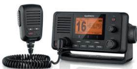
Rádio marítimo VHF de montagem fixa compatível com a segunda estação de mão com fio GHS 11 VHF Handset. Ele tem potência de transmissão de 25 watts com GPS embutido e DSC Classe D padrão, de fácil instalação plug-and-play com conexão com chartplotters e MFDs compatíveis através da rede NMEA 2000®.
