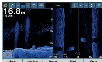
O motor de proa Force vem com um transdutor integrado com tecnologias CHIRP tradicionais e UHD ClearVú/SideVú com interferência imperceptível nas imagens de sonar.
